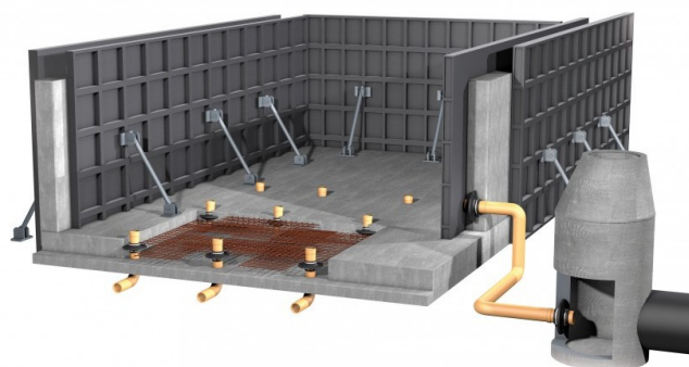
Úszómedence elfolyók átvezetése falon és aljazaton
